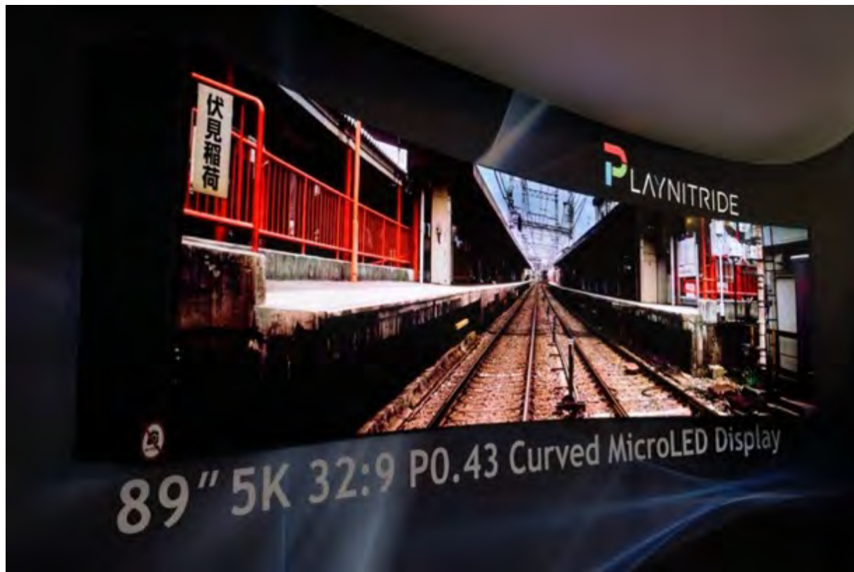
89" 5K 32:9 P0.43 曲面 Micro LED 顯示器
