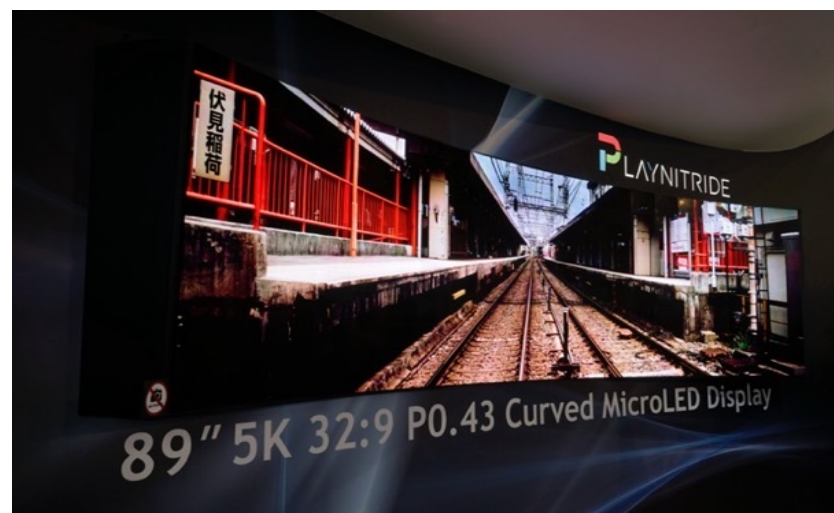
89" 5K 32:9 P0.43 曲面 顯示器 (Seamless tiling by 168 modules)
