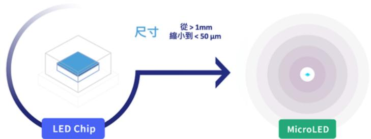
將數百萬個微米 (  $\mu$ m ) 等級的 MicroLED 晶片以「巨量轉移 ( Mass Transfer )」方式，移轉到含電路結構設計的驅動背板上，搭配不同驅動技術，創造出各種尺寸與領域的顯示器應用。
